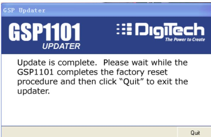
当升级程序进行到这里，GSP1101 还需要一定的时间进行更新，请留意 GSP1101 的显示屏幕，直到 GSP 显示屏回到常规开机后的主界面，出现预设 1 的界面就代表升级程序已经完成，如需要导入用户预设请运行 X-Edit 软件。
