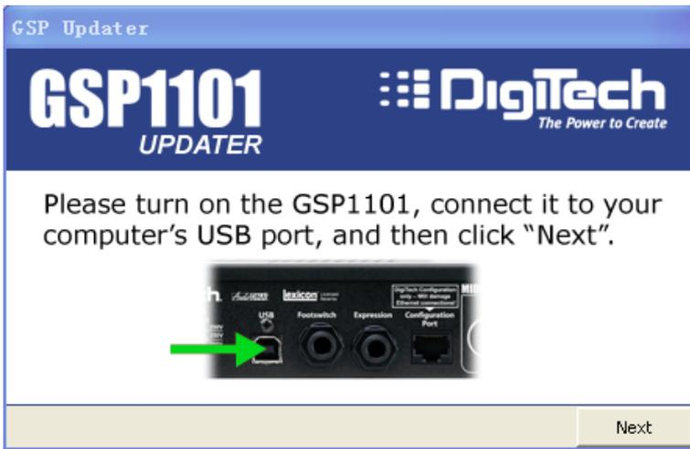
出现此界面后重新将 GSP1101 与电脑连接并打开电源，GSP 的 USB 指示灯将亮起(数据轮旁边的蓝色灯)，点击 Next。
