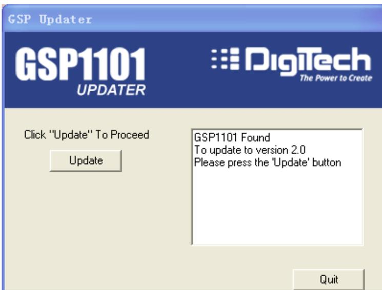
当出现以上界面，升级程序准备就位，在这之后的步骤中绝对不能断开 GSP 与电脑的连接，也不能断开 GSP 的电源与电脑的电源，请务必小心操作，否则将造成无法挽回的损坏，电脑不要运行其他的程序及任务，避免死机的情况出现。一切准备就绪点击 Update。整个升级需要大概 5 分钟左右，右边的窗口会显示升级进度，GSP 的显示屏幕也会出现相应的字符，请耐心等待，直到出现下图
