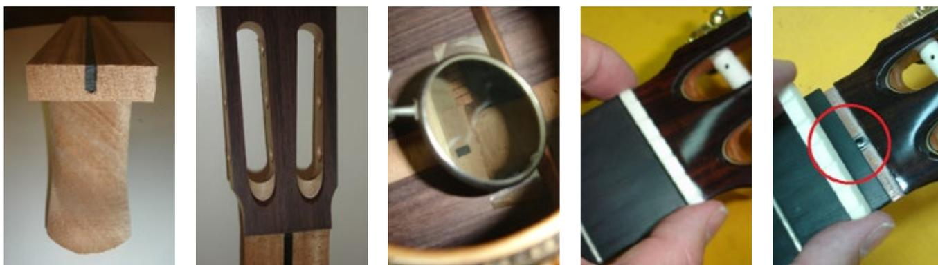
Este refuerzo confiere una rigidez adicional a la guitarra. La tira de ébano va desde la parte inferior del mango, integrada en el tacón, hasta la cabeza del instrumento, y a lo largo de todo el mango. Todos los modelos a partir del 5 P incorporan este refuerzo. El refuerzo únicamente es visible al quitar la cejuela o a través de la boca, como muestran las fotografías.
